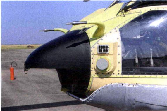
*Detalhe dos sensores RWR e MWS instalados à frente da cabine de pilotagem do EC725-BR. Esses sensores, instalados aos pares em posições específicas na fuselagem, permitem a detecção de ameaças em todas as direções em torno da aeronave.*
