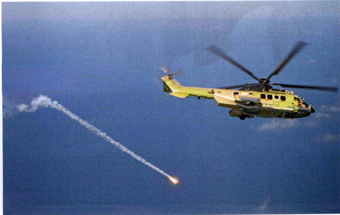
*Vista do EC725-BR empregado na campanha de testes do sistema EWS imediatamente após o lançamento de um flare. O EC725-BR empregado pertence ao lote sendo atualmente fabricado para a Aviação Naval.*
