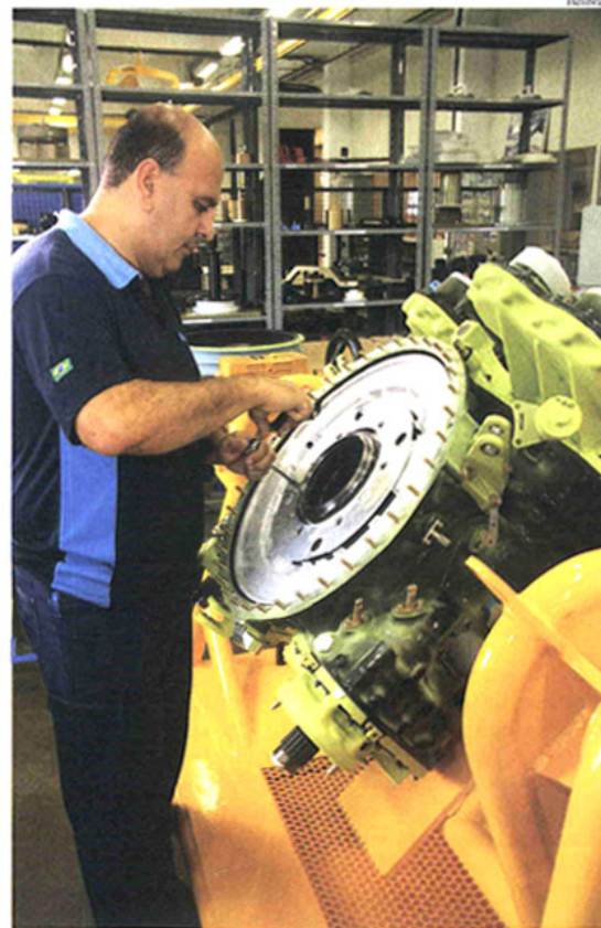
A montagem da MGB (Main Gear Box) do EC225/725 nas oficinas da Helibras, em Itajubá (MG), trará uma série de conhecimentos e know-hows sem precedentes, já que esse item é o que congrega mais funções e componentes dinâmicos da aeronave. Tem-se aí a grande transformação de energia, dos motores aos rotores via um complexo sistema de engrenagens redutor (transforma velocidade em força), o acionamento de bombas de óleo lubrificante e hidráulico mais os geradores, e, visando à segurança, os detectores de limalha, sensores de alarme e instrumentos de controle.
