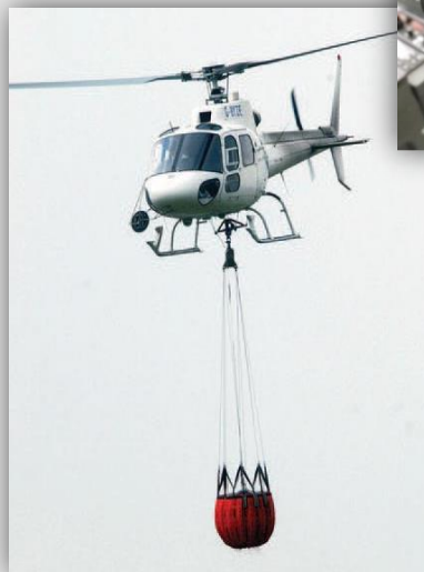
Esquilo equipado com Bambi Bucket
