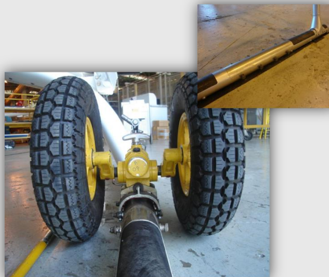
Proteção dos Patins com as “rodas de rolagem”
