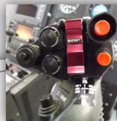
Cíclico com o sistema Bucket
