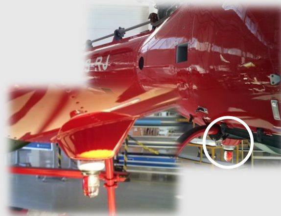
Luz Estroboscópica na Região Ventral
