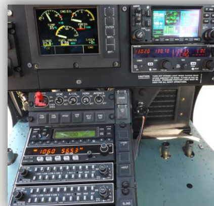
Instalação Sistema Seletor de Áudio KMA 24H-71 Dual
