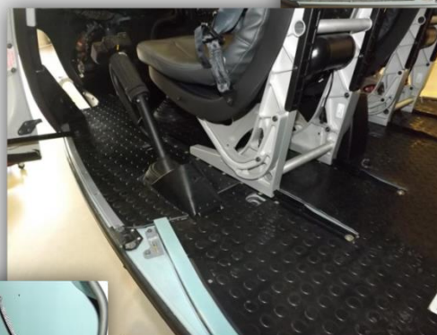
Tapete de Borracha na cabine
