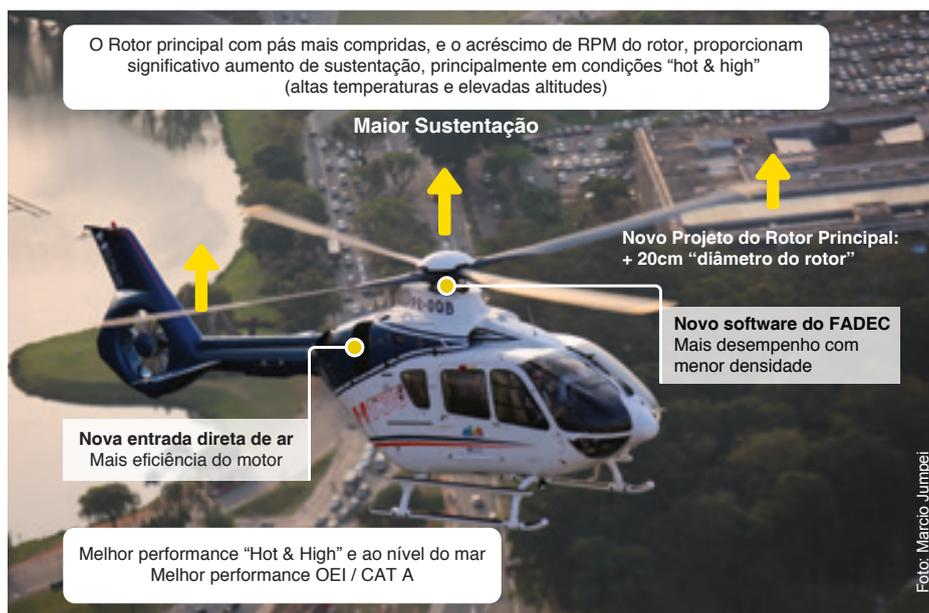
O Rotor principal com pás mais compridas, e o acréscimo de RPM do rotor, proporcionam significativo aumento de sustentação, principalmente em condições "hot & high" (altas temperaturas e elevadas altitudes)
